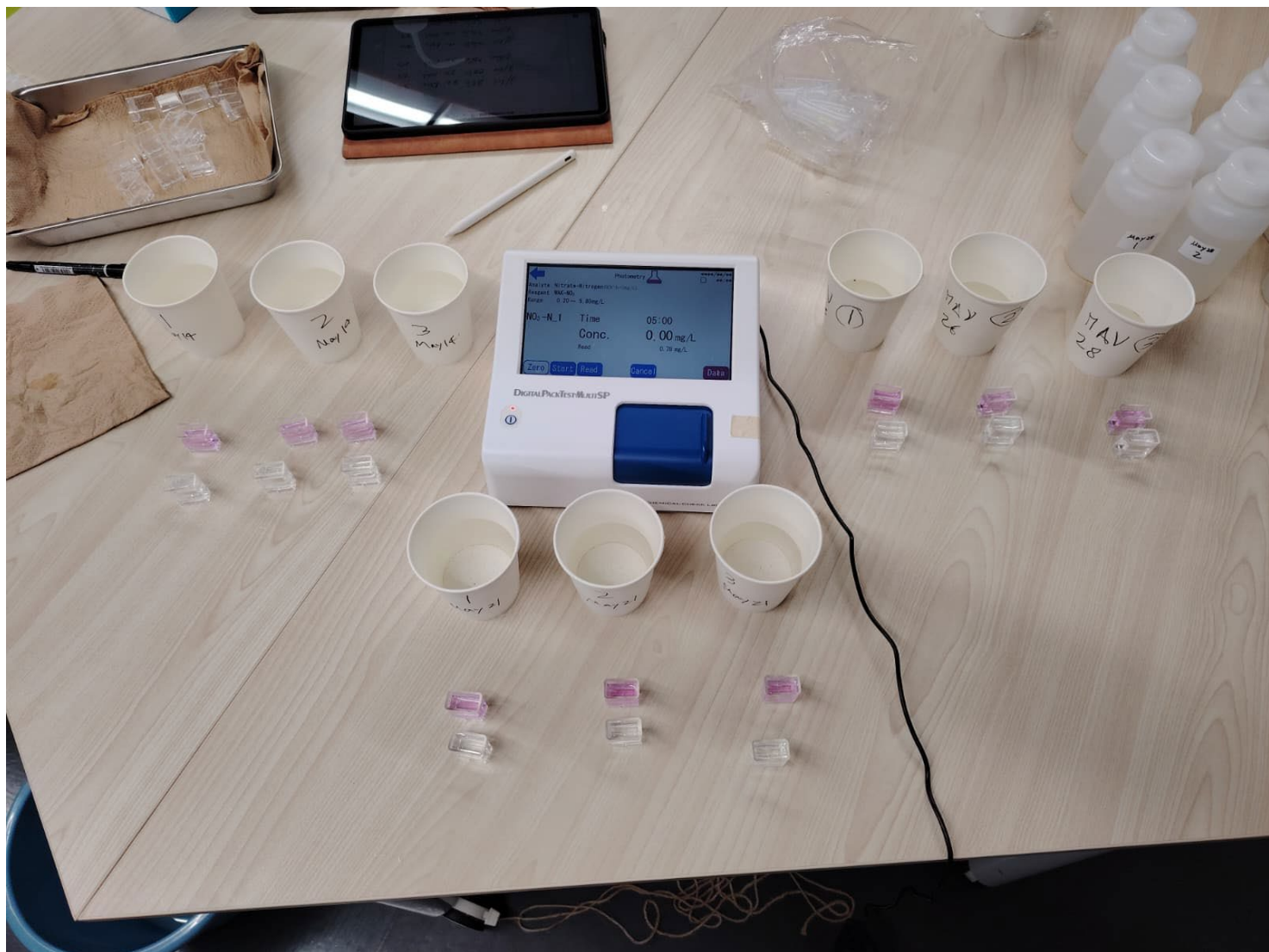
Fig. 4 Digital Packtest analysis
